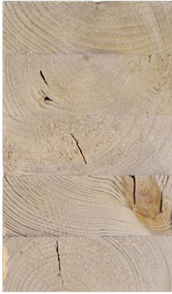
Antikes Brettschichtholz Lärche gedämpft | gehobelt | Sichtqualität | GL20
